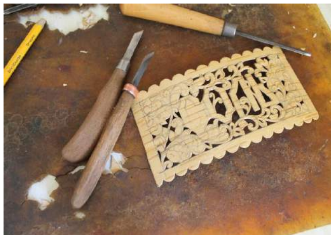
Рисунок 6. Инструмент для вырезания по бересте: шило, нож Figure 6. Tool for cutting on birch bark: awl, knife
