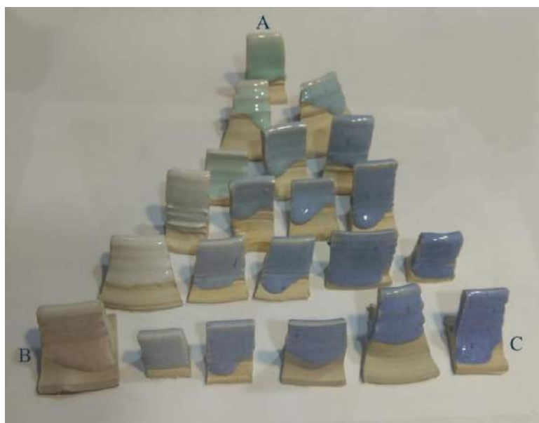
Рисунок 8. Пробники глазурей с оксидами в разных пропорциях А – 1 % оксида меди, В – 1 % оксида марганца, С – 0,2 % оксида кобальта
