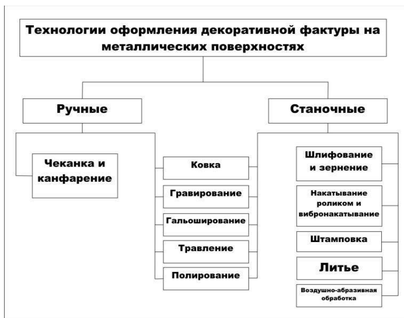
Рисунок 1. Классификация технологий фактурирования поверхностей изделий из металлов и сплавов
