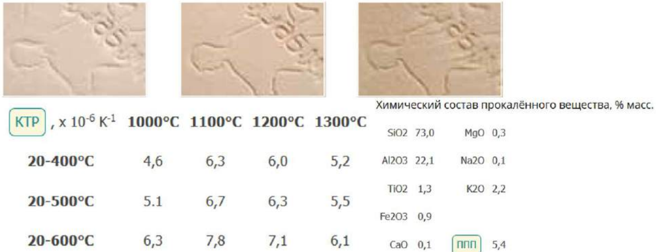
Рисунок 14. Керамическая масса Witgert 11 sf и её КТП с химическим составом Figure 3. Witgert 11 sf ceramic mass and its TEC with chemical composition
