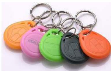
Рисунок 2. Разновидности бесконтактных ключей от домофона Figure 2. Varieties of contactless keys to the intercom
