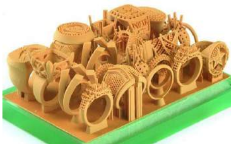
Рисунок 3. Кольца после печати на 3D принтере
