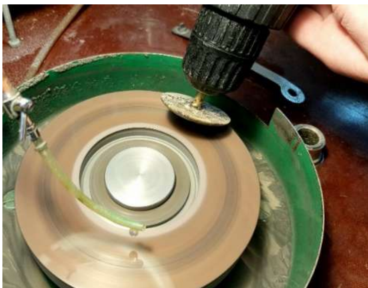
Рисунок 3. Шлифовка кабашона на планшайбе 40/28 мкм Figure 3. Cabochon grinding on a 40/28 \mu\text{m} lap
