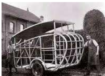
Каркас прицепа-дачи Уолли Бяма. 1930 г.
