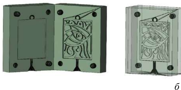
Рисунок 4. Цифровая модель пресс-формы в программе SolidWorks: а – рабочая поверхность пресс-формы, б – собранная пресс-форма
