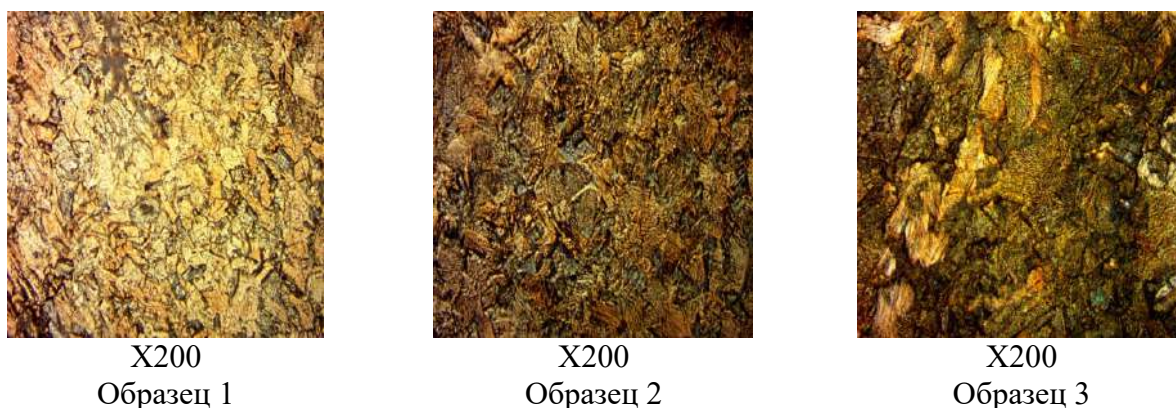
Рисунок 2. Структура покрытия образцов, при разных плотностях тока. Figure 2. Coating structure of samples at different current densities.
