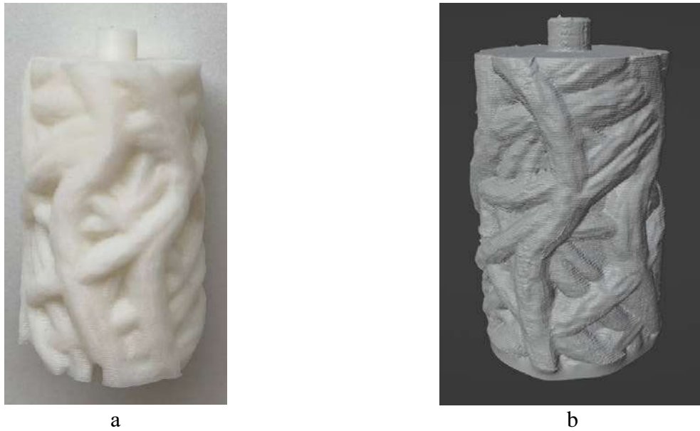
Рисунок 8. Декоративный элемент: a – распечатанная 3D модель; b – результат сканирования Figure 8. Decorative element: a – printed 3D model; b – scanning result
