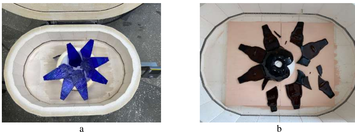
Рисунок 1. Закалка при 780°C: a – синие бутылки; b – коричневые бутылки
