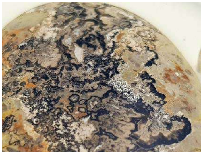
Рисунок 2. Выделение воздушных пузырей во время заполнения пор образца эпоксидной смолой
