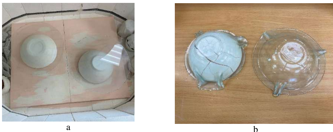
Рисунок 2. Обжиг при температуре 780°C: a – до обжига; b – после обжига
