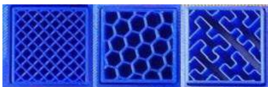
Рисунок 4. Различные паттерны заполнения модели Figure 4. Various geometric 3D print patterns
