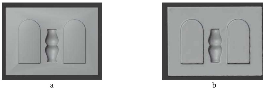
Рисунок 2. Сравнение изначальной модели и отсканированной: а – спроектированная модель до сканирования; б – модель после сканирования Figure 2. Comparison between the original model and the scanned model: а – designed model before scanning; б – the model after scanning
