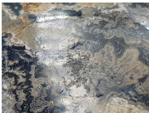
Рисунок 9. Дефекты полировки поверхности кабошона Figure 9. Defects in the polishing of the cabochon surface
