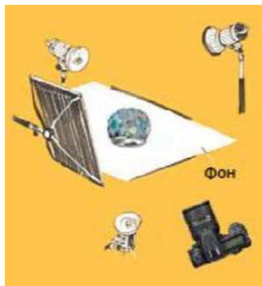
Рисунок 3 — Схема освещения предмета при фотосъемке
