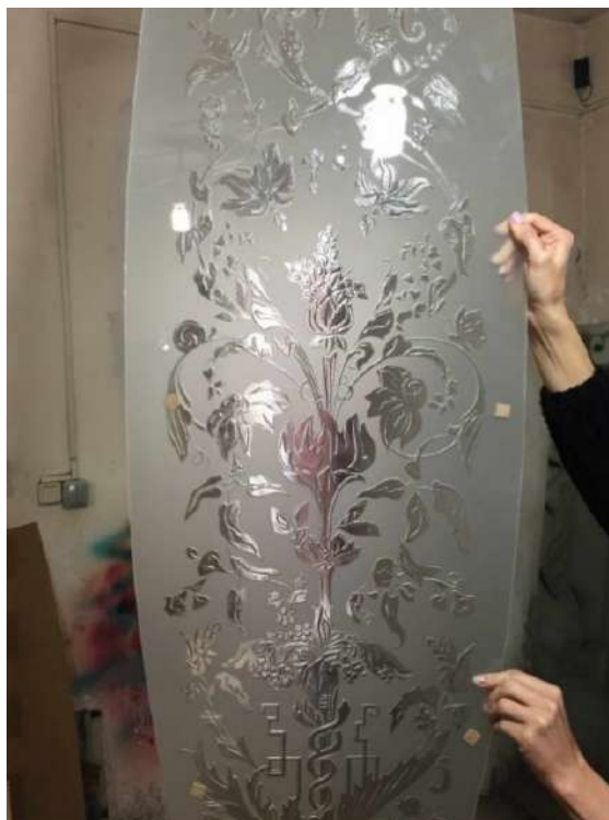
Рисунок 4 – Пескоструйная отделка стекла
