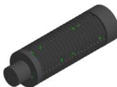
Рис.4. Результат операций «Элемент вращения» и «Элемент выдавливания»
