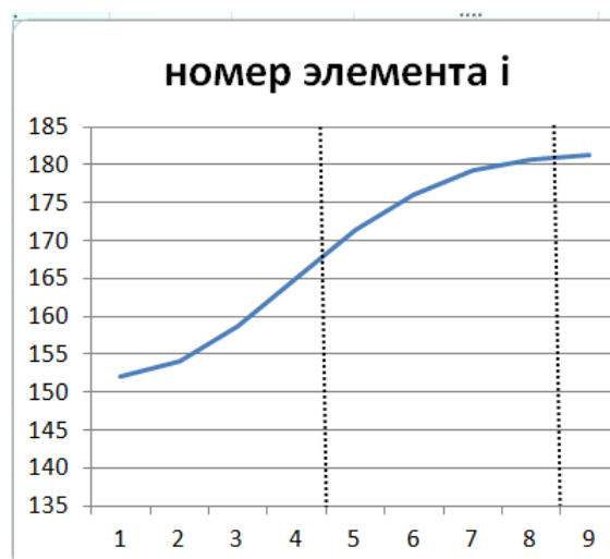
Рис 5. Распределение температуры вдоль рабочей поверхности цилиндра
