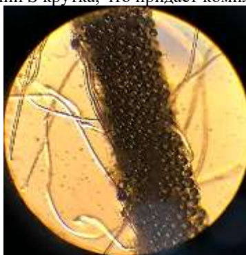
Рис. 1. Фото световозвращающей нити под микроскопом
