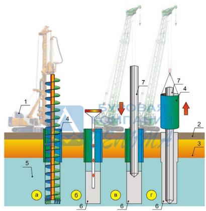
Рис. 3. а - бурение скважины; б - заполнение скважины песчано-глинистым раствором; в - погружение сваи; г - извлечение обсадной трубы; 1 - буровая установка; 2 - подсыпка; 3 - деятельный слой грунта; 4 - обсадная труба; 5 - мерзлый грунт; 6 - песчано-глинистый раствор; 7 - свая.
