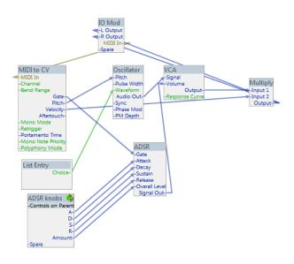
Рис. 2. Схема плагина-гененератора Oscillator (SynthEdit)
