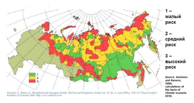
Рис. 2. Риск разрушения зданий в зоне вечной мерзлоты
