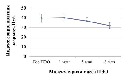
Рис. 2. Зависимость сопротивления разрыву от молекулярной массы полиэтиленоксида
