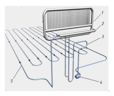
Рис.4. Опытная схема системы ГЕТ: 1 — конденсаторный блок, 2 — ускоритель циркуляции, 3 — гидрозатвор, 4 — грязевик,
