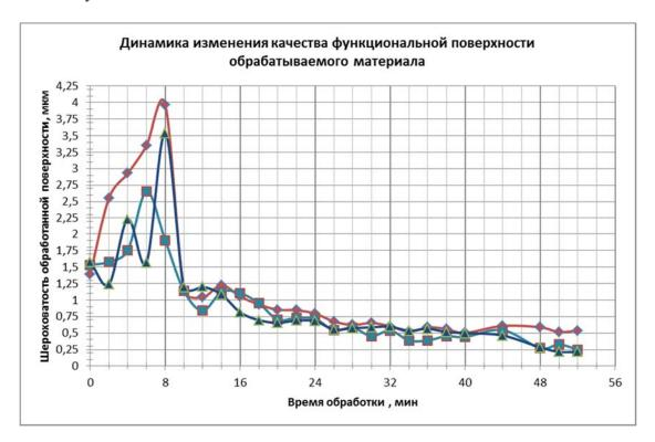
Рис. 2. Динамика изменения качества поверхности трех исследуемых образцов ситаллов
