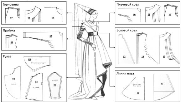
Рис. 1. Типизация конструктивных решений узлов и срезов платьев готического периода средневековья
