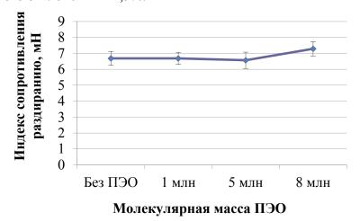
Рис. 3. Зависимость сопротивления раздиранию от молекулярной массы полиэтиленоксида
