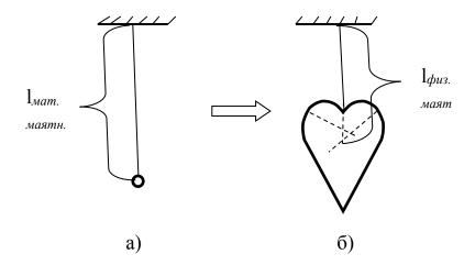
Рис. 1 Математический маятник – а), физический маятник при разных положениях точки подвеса - б).
