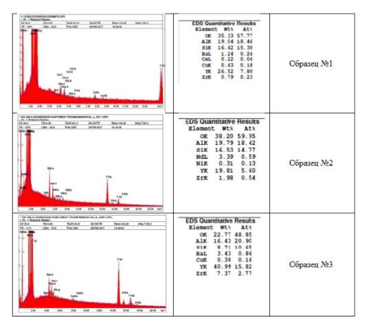
Рис. 3. Элементный анализ исследуемых образцов
