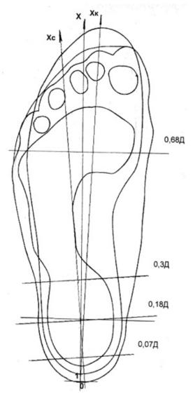
Рис.1. Проектирование следа колодки по плантограмме стопы
