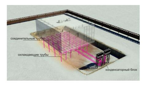
Рис. 5. Система ВЕТ в основании сооружения
