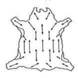
Рис. 4. Наибольшее удлинение при растяжении кожи
