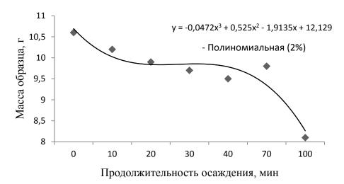
Рис. 2. Кинетика удаления растворителя при пленкообразовании из растворов с концентрацией коллагена 2 %
