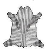
Рис. 3 Преобладающее направление волокон на разных частях кожи
