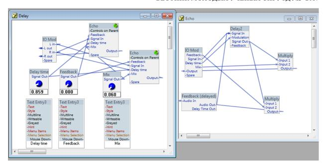
Рис. 4. Схема плагина-эффекта Delay (SynthEdit)
