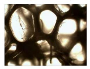
Рис 2. Структура неопрена под микроскопом
