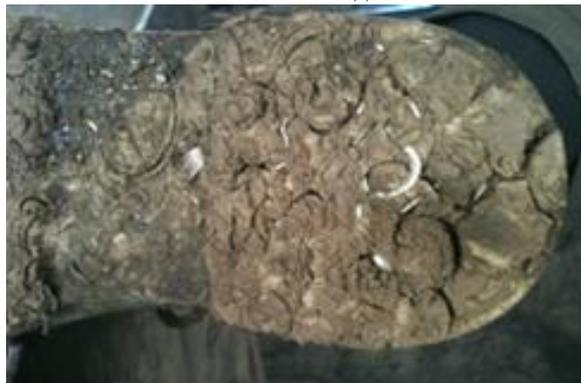
Рис. 6. Повреждение подошвы металлической стружкой
