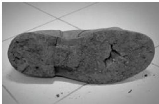
Рис. 4. Разрушение ПУ подошвы
