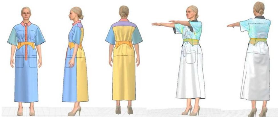
Рис.2. Виртуальная примерка модельной конструкции в Clo 3d
