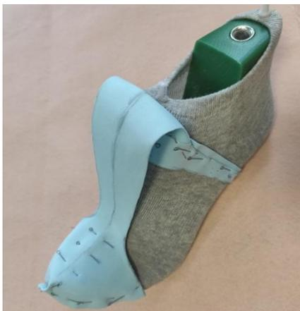
Рис. 3. Моделирование передней составной детали
