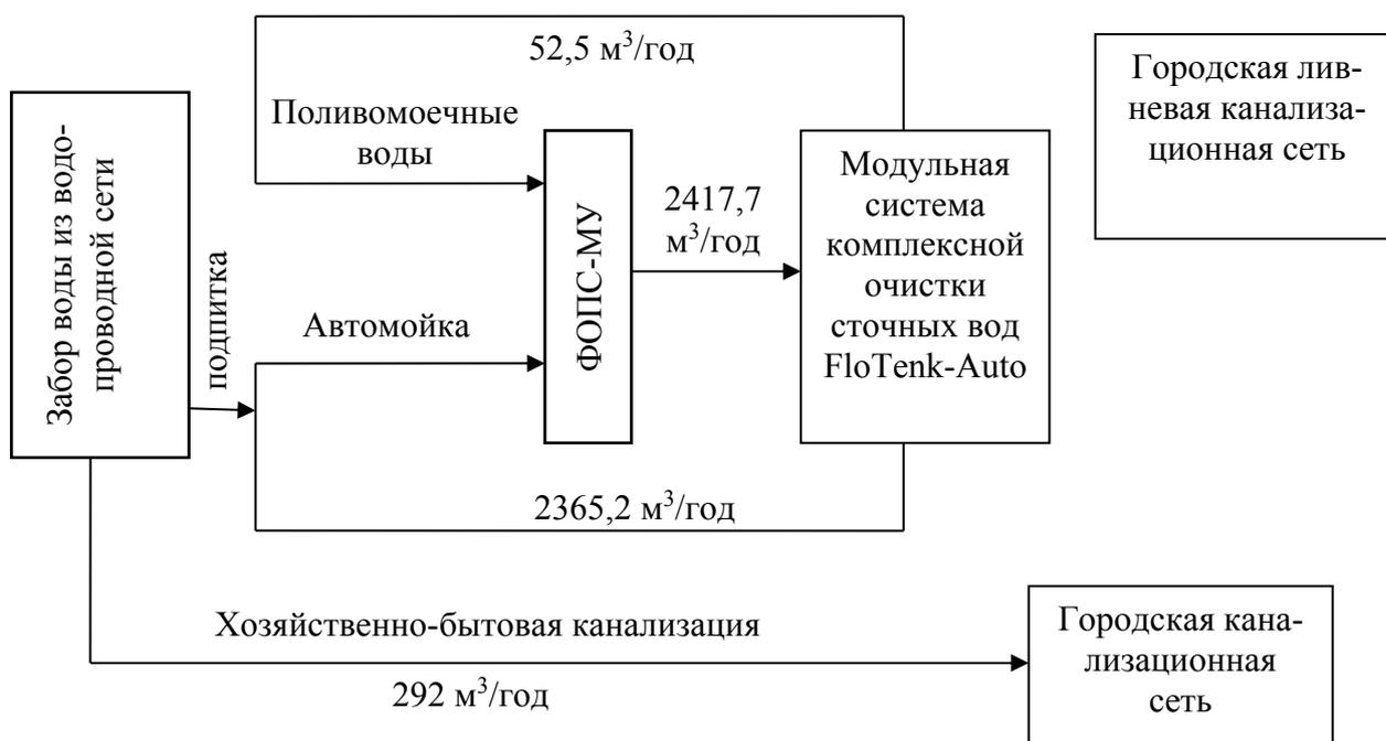
Рис. 3. 3 вариант - схема водного баланса при замене установленных ЛОС модульной системой комплексной очистки сточных вод FloTenk-Auto с установкой фильтра ФОПС-МУ.
