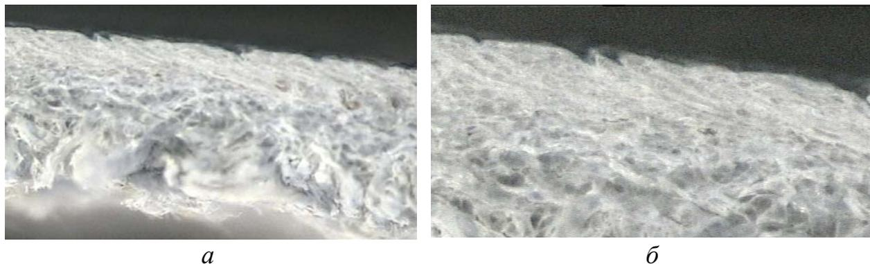
Рис.4. Срез под микроскопом Microcolor 2000 250В-LAB натуральной подшлифованной кожи с нанесением рисунка с помощью UF печати: а) увеличение образца в 51 раз, б) увеличение образца в 80 раз
