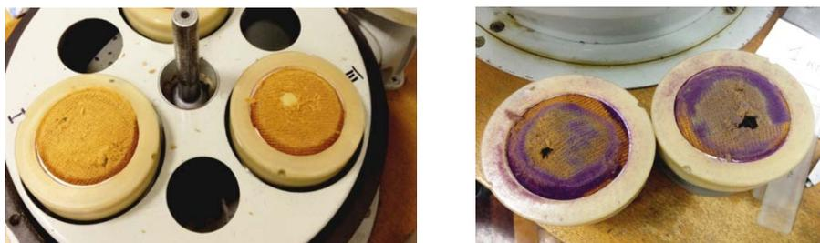
Рис.3. Головки с первым разрушением структуры образца без флюка (а) и с флюком (б)
