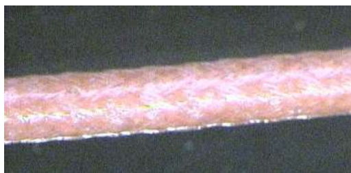
Рис. 7. Продольное сечение струны Yonex Aerobite
