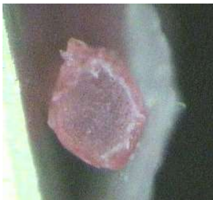
Рис. 1. Поперечное сечение струны Yonex BG 80
