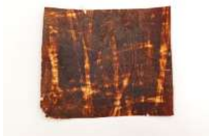
Рис.2. Композит с ФФС по технологии прокапывания (сторона 1)
