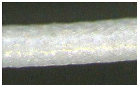
Рис. 8. Продольное сечение струны Yonex Aerosonic
