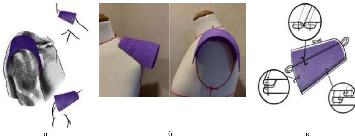
Рисунок 5 – Иллюстрация процесса изготовления плечевой накладки из полимерного бинта: а – эскиз; б – макетирование; в – вариант технологической обработки чехла для ПН
