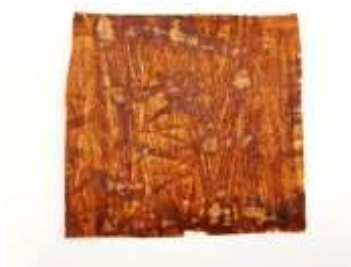
Рис.5. Композит с ФФС по технологии вымачивания (степень наполнения 80%)
