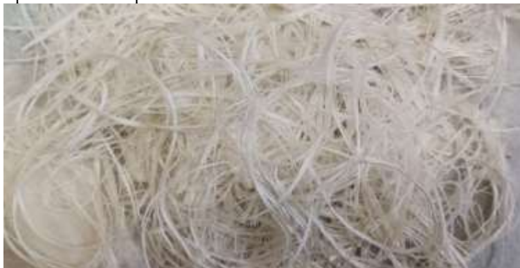
Рис. 1. Стекловолокнистые отходы с производства стеклопластиков
