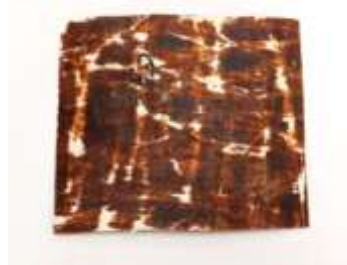
Рис.3. Композит с ФФС по технологии прокапывания (сторона 2)
