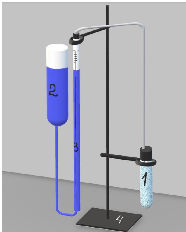
Рис. 1. Лабораторная установка: 1 – пробирка с реакционной смесью, закрытая пробкой; 2 – уравнивательный сосуд; 3 – бюретка с измерительной шкалой, заполненная подкрашенной водой; 4 – штатив
